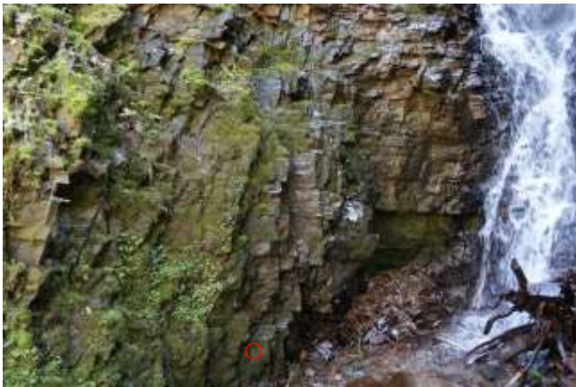
写真 20-4 スレート劈開面の走向, 傾斜を比較的滑らかな面を選び, クリノコンパスを用いて4ヶ所で測定した(右写真の測定状況は左写真の赤○部分). 走向は N45^{\circ}W \sim N62^{\circ}W , 傾斜は 74^{\circ} \sim 85^{\circ}NE . 走向の方向性は左横ずれ断層のミ型雁行配列(日本地質学会地質基準委員会 2003)を示すものかもしれない。
