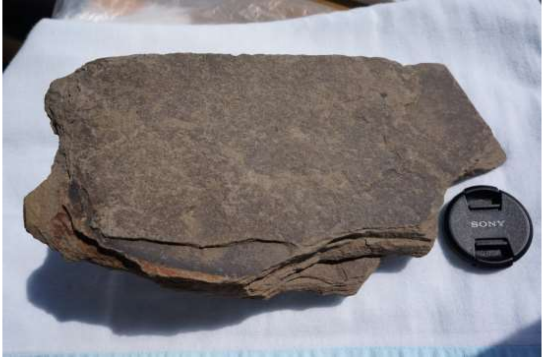
写真 20-5-1 20-2 の岩石試料, 粘板岩(スレート: slate)と見られ, 間隔の細かな平行面群に沿って薄くはがれやすくなっており, 劈開が発達した泥質堆積岩起源の変成温度の低い広域変成岩である(都城・久城 1975). (2014/09/23 12:17 撮影)
