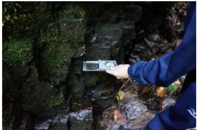
写真 20-4 スレート劈開面の走向, 傾斜を比較的滑らかな面を選び, クリノコンパスを用いて4ヶ所で測定した(右写真の測定状況は左写真の赤○部分). 走向は N45^{\circ}W \sim N62^{\circ}W , 傾斜は 74^{\circ} \sim 85^{\circ}NE . 走向の方向性は左横ずれ断層のミ型雁行配列(日本地質学会地質基準委員会 2003)を示すものかもしれない。
