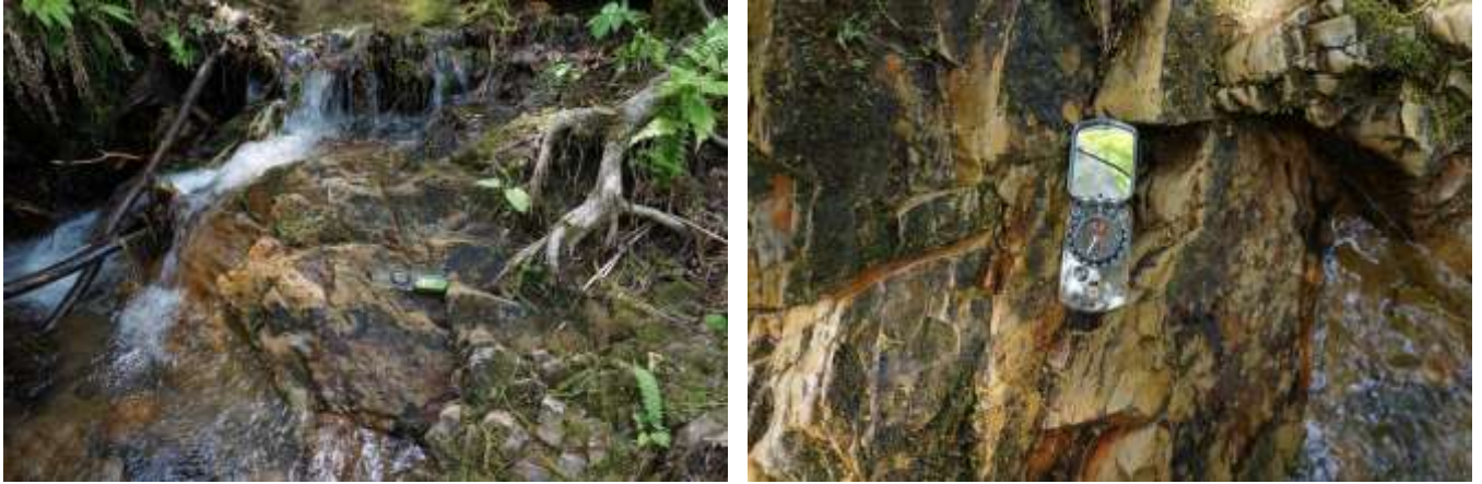
写真 10 おその沢沿いの層理面があらわれた泥岩露頭. 偏角補正をして走向 N26^{\circ}W , 傾斜 38^{\circ}NE . (2014/05/24 12:30 撮影)
