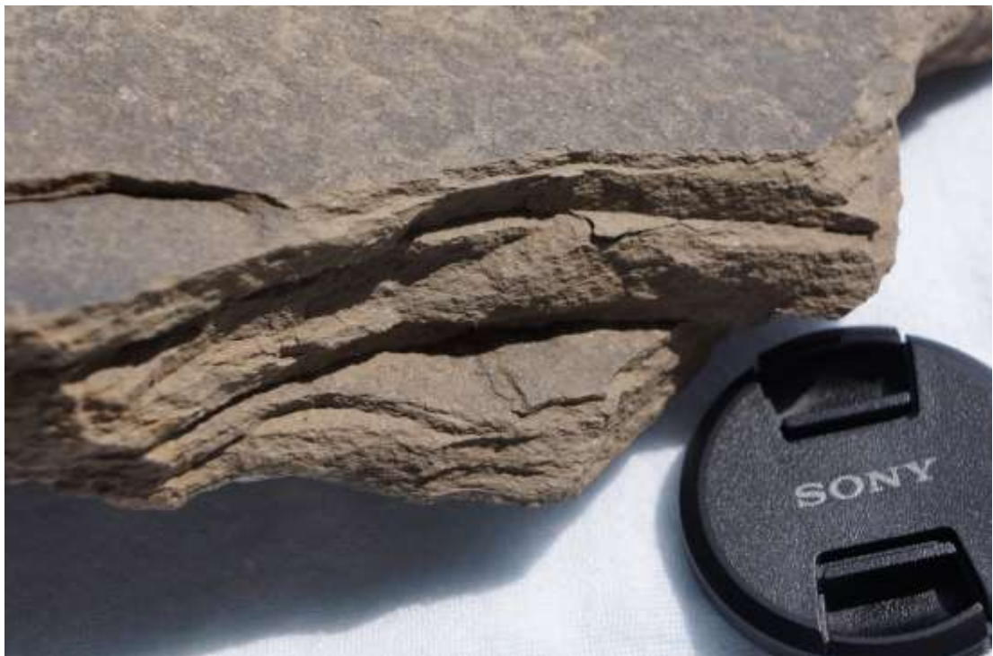
写真 20-5-2 前面を太陽光の強い光のもとで接写した. 劈開面には輝きを放つ微小な鉱物粒子が見られ, ルーペで観察すると白雲母や石英のようである(2014/09/23 12:20 撮影).
