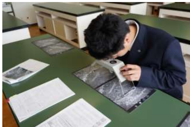
空中写真判読 反射実体鏡 MS16(SOKKIA).
